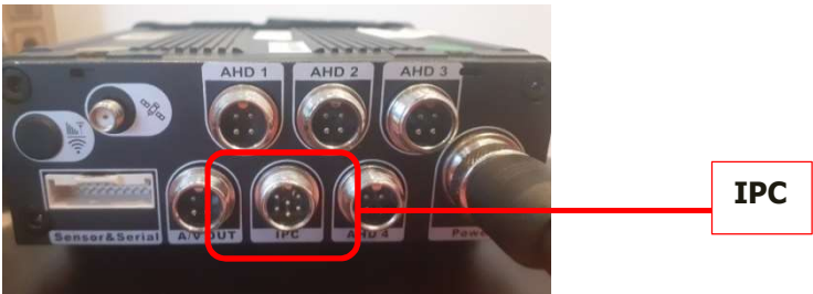
Figura 3 - Conexão IPC do MDVR 04 canais
